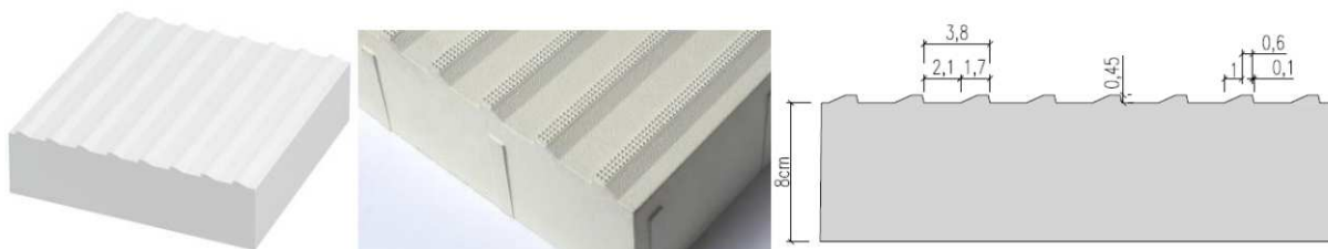
Rys.1c. Płytki kierunkowa z wypustkami trapezoidalnymi asymetrycznymi - (stosowane tylko na pochylniach dla wózków inwalidzkich).
